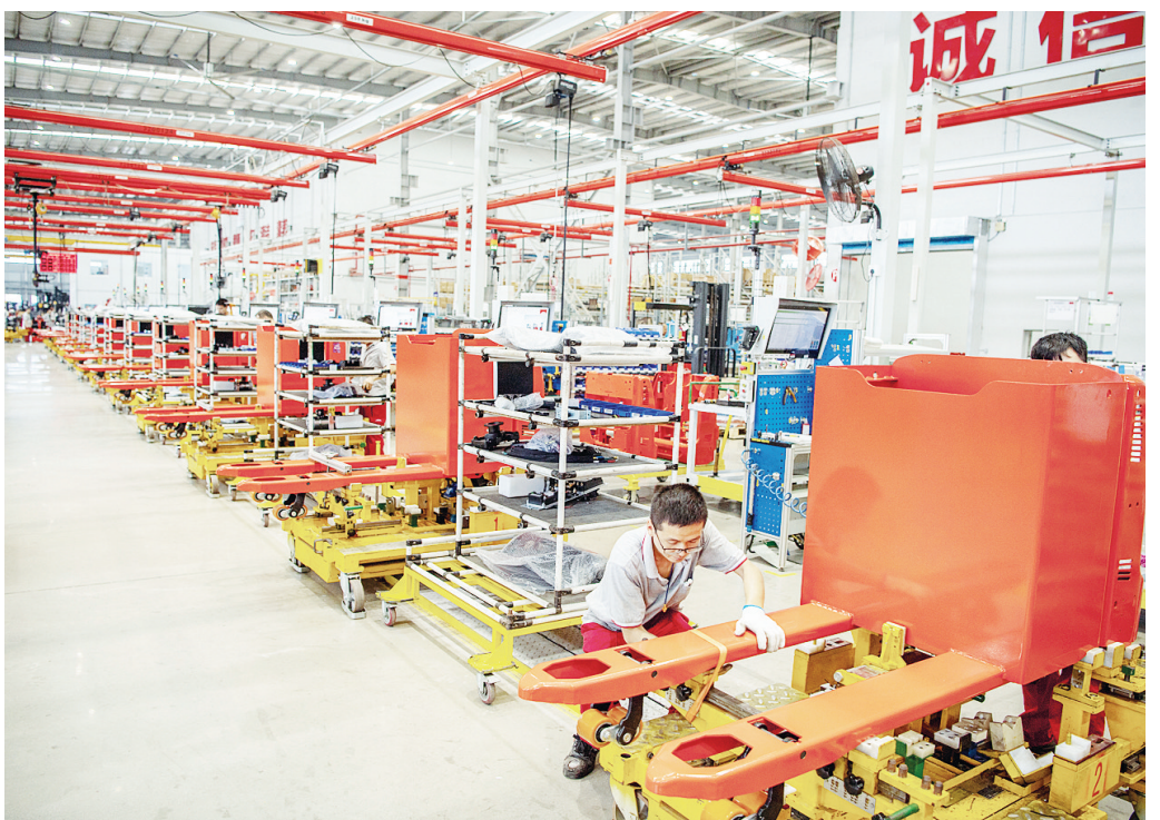
由德国凯傲集团与福建海山重工有限公司共同投资建设的凯傲漳州工厂内,技术人员按照标准作业流程,有序装配叉车。该工厂主要生产新能源智能叉车、装载机、港口和仓储物流专用车,产品达国内领先水平。 游斐洲 摄
