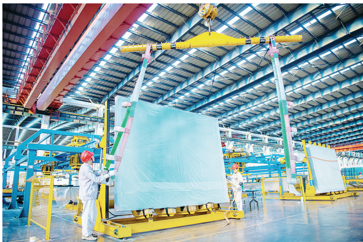
漳州旗滨玻璃有限公司现有8条优质玻璃生产线,主要生产优质浮法、TCO镀膜、在线low-e节能等玻璃。 游斐洲 摄
