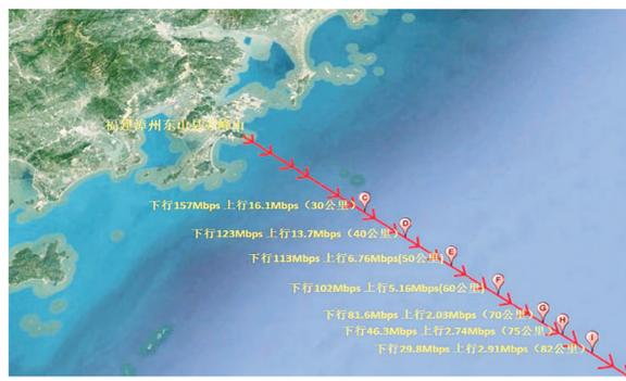
手机测试结果表明,在距离海岸线82公里时,仍可达到29.8Mbps的下载速率以及2.91Mbps的上传速率,可实现海上5G语音、视频通讯、数据传输等业务需求。漳州电信 供图
